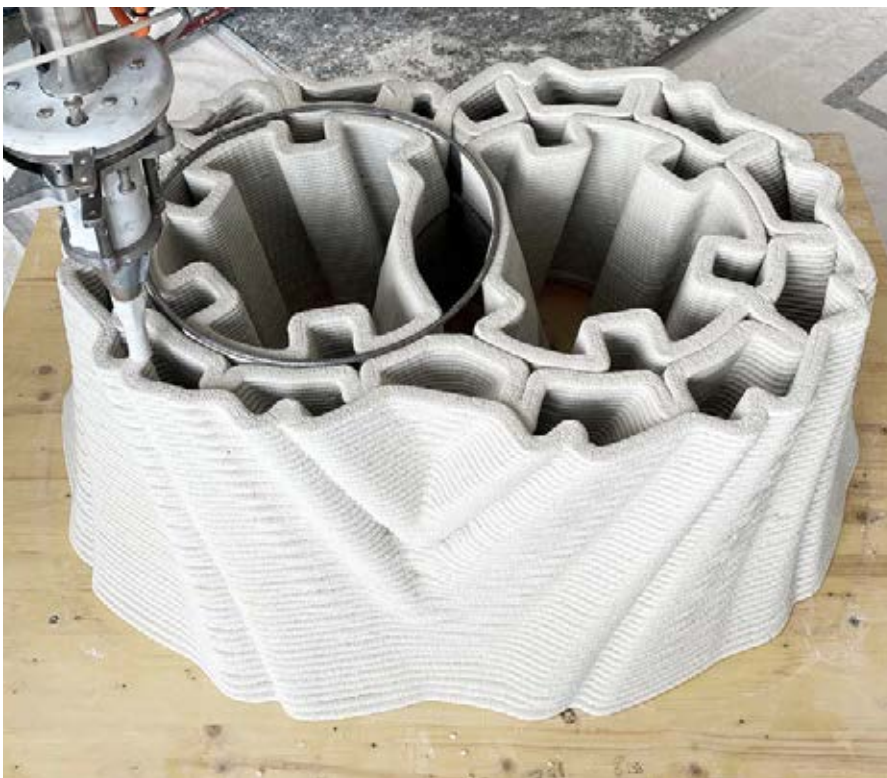
Für den 3D-Druck der Säulenelemente hat ETH-Professor Robert Flatt einen neuartigen Betonmix entwickelt.
